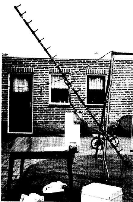
23 el. F9FT opgesteld op een tafeltje in een bankschroef i.v.m. de elevatie.
